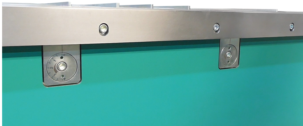
Bombiervorrichtung für die Biegewange
