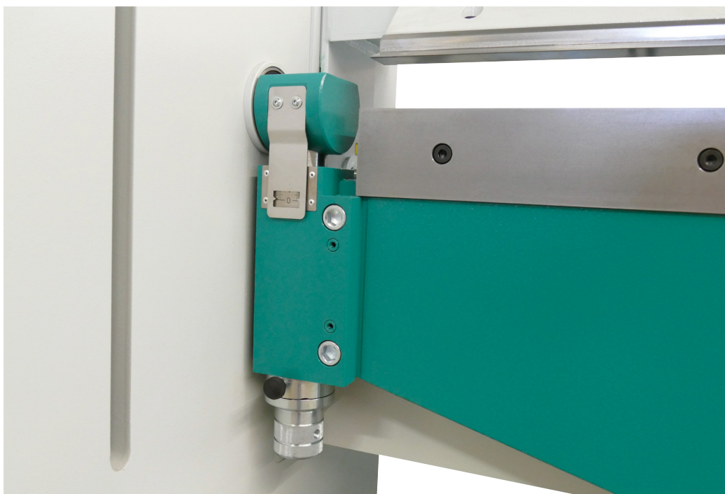
Einstellung des Biegeradius über Drehnocke
