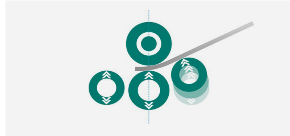
2. Anbiegung, das Blech wird zwischen den Zentralwalzen geklemmt
