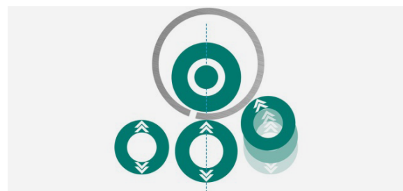
4. Zweite Anbiegung am Ende der Rundung
