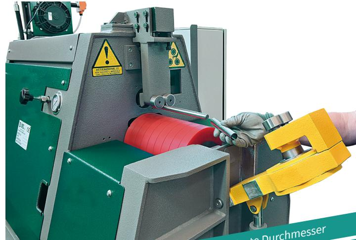
Sonder-Oberwalzen für kleinste Durchmesser
