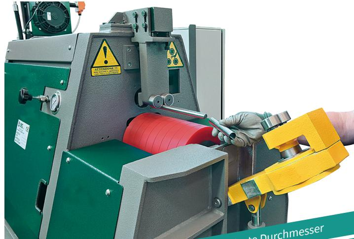
Sonder-Oberwalzen für kleinste Durchmesser
