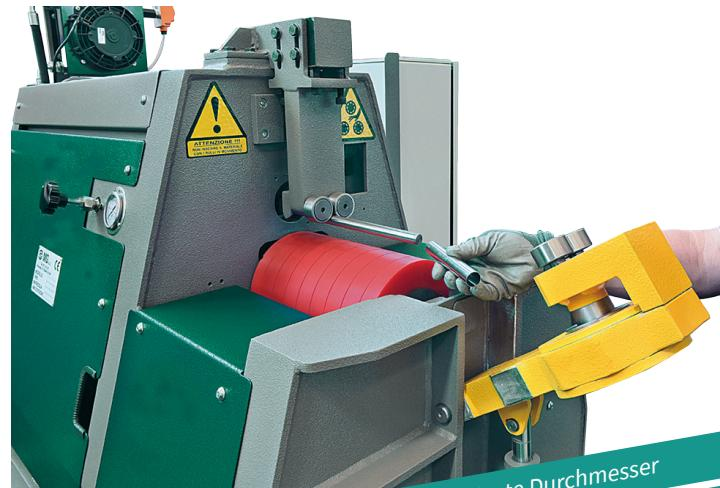
Sonder-Oberwalzen für kleinste Durchmesser
