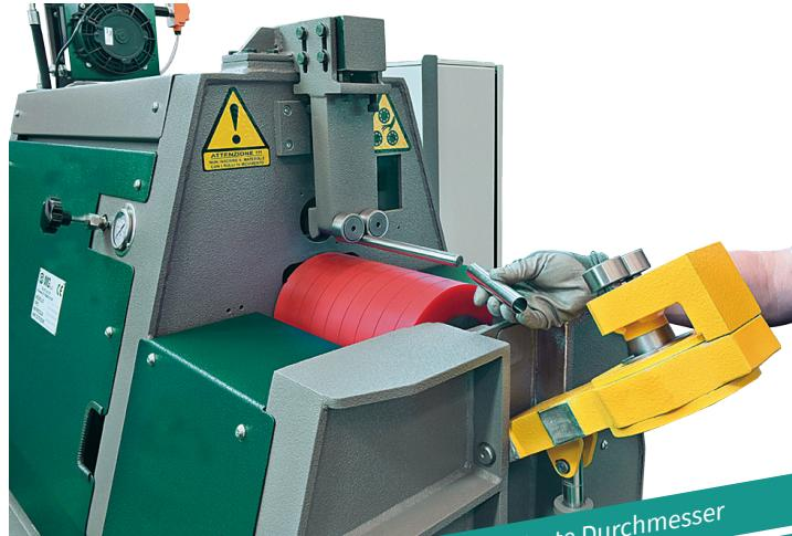
Sonder-Oberwalzen für kleinste Durchmesser
