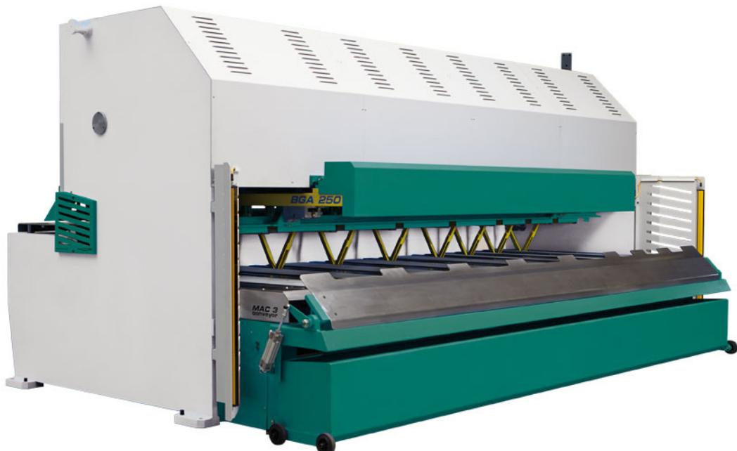
Zuschaltbare, pneumatische Arme fahren vertikal nach oben um das Blech zum Einmessen am Hinteranschlag zu unterstützen. Klemmen die Niederhalter das Blech auf der eingemessenen Positionen senken sich die Arme ab.
