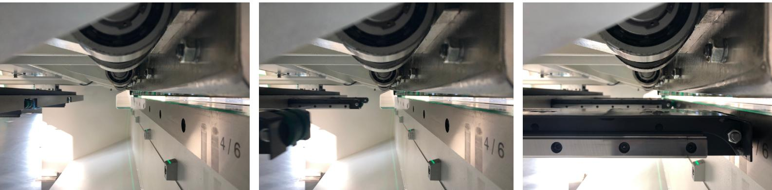
Die Blechrutsche kann seitlich mit einer Kippplatte unterbrochen werden. Kurze Abschnitte fallen dann nach vorne in eine Material-Schublade (Option HGR-RUTSCHE).
