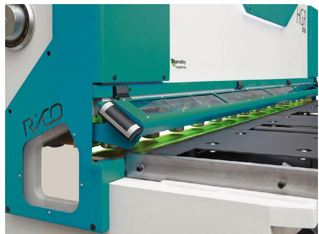
Der Fingerschutz kann über die gesamte Schneidlänge aufgeklappt werden, um kleine Blechstücke besser positionieren zu können. Ein Endschalter blockiert die Niederhalter und die Schneidfunktion – erst nach Schliessen des Fingerschutzes und der Quittierung auf dem Bedienpult kann wieder geschnitten werden – der Bediener wird optimal geschützt.
