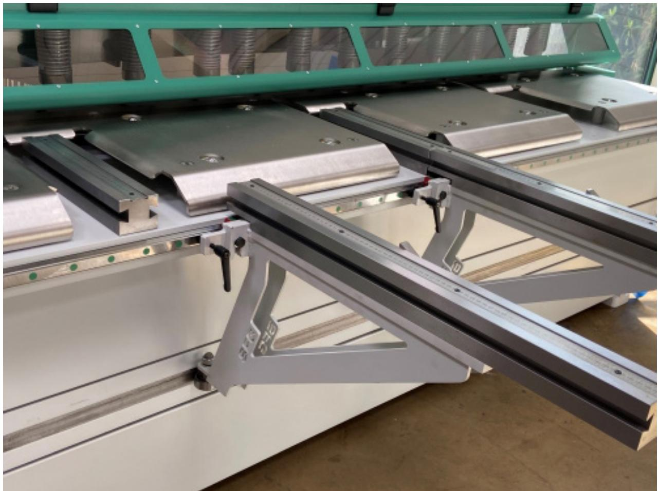
Die Auflagearme gleiten leicht auf einer Linearführung
