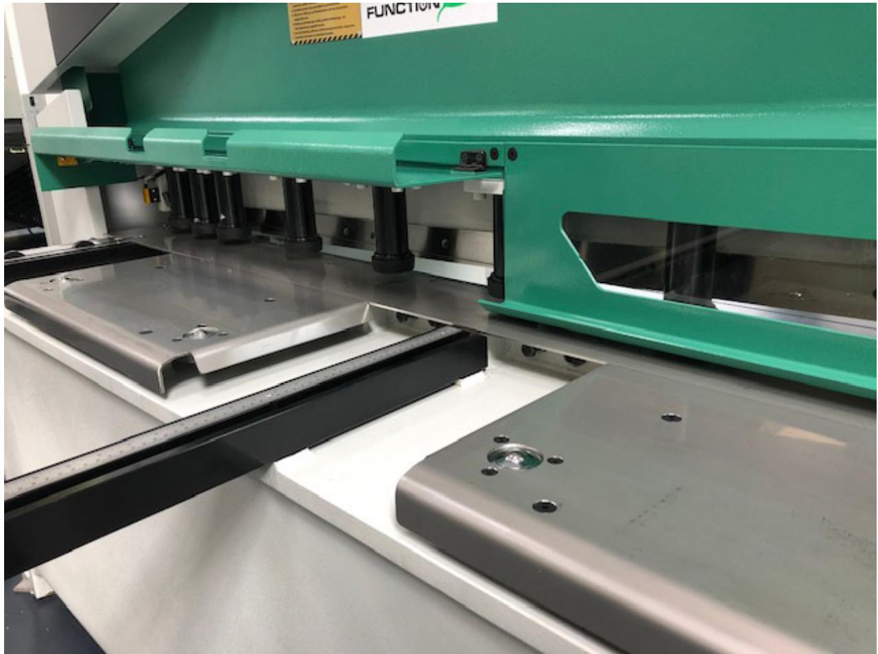
Der Fingerschutz kann auf den ersten 1.000 mm der Schneidlänge aufgeklappt werden, um kleine Blechstücke besser positionieren zu können. Ein Endschalter blockiert die Niederhalter und die Schneidfunktion – erst nach Schliessen des Fingerschutzes und der Quittierung auf dem Bedienpult kann wieder geschnitten werden – der Bediener wird optimal geschützt.
