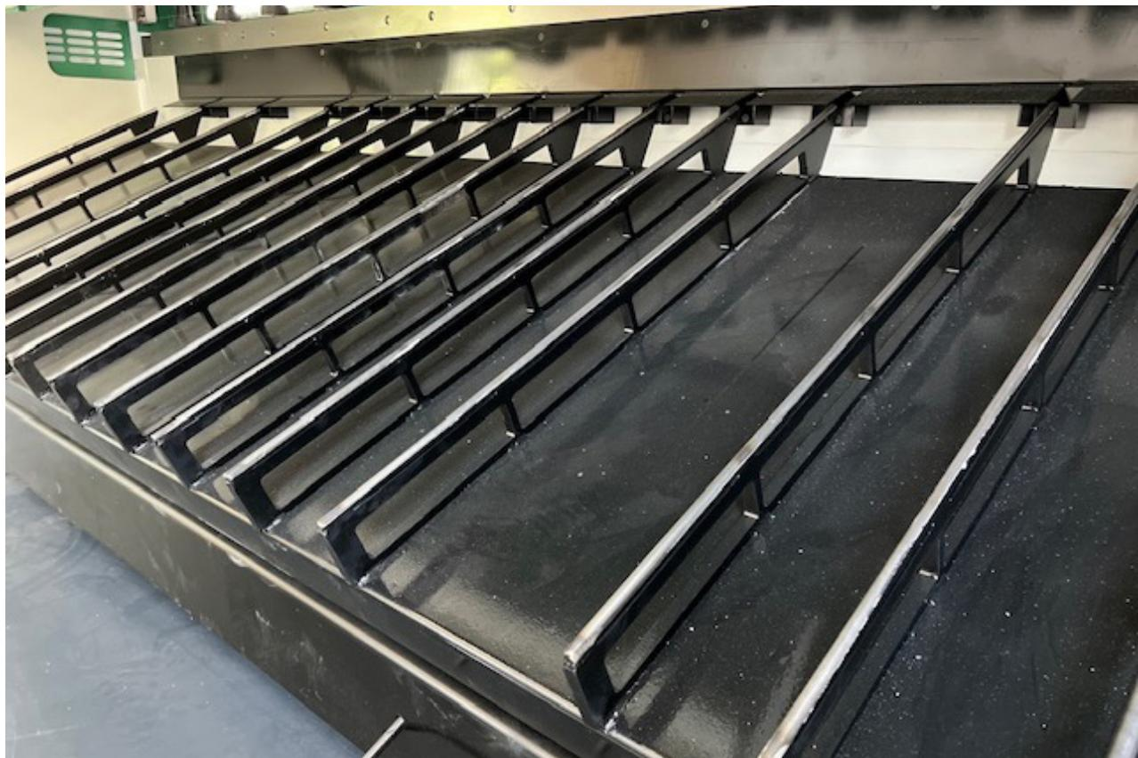
Zuschaltbares pneumatisches Blechhochhalte-System mit Unterstützung des Blechabschnitts während des Schnittes. Nach dem Abschnitt kippen die Auflagen schräg ab und der Abschnitt rutscht nach hinten aus der Maschine.
