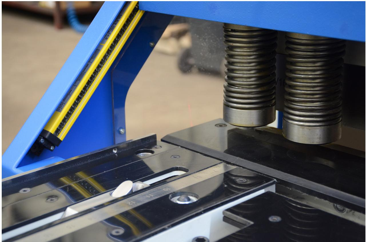
Der mechanische Fingerschutz wird durch einen Lichtvorhang ersetzt. Wird einer der Lichtstrahlen unterbrochen kann weder die Niederhalter noch der Messerbalken ausgelöst werden. Der Bediener ist durch diese optische Überwachung geschützt.
