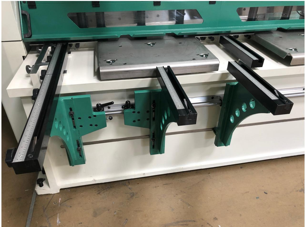
Die Auflagearme gleiten leicht auf einer Linearführung
