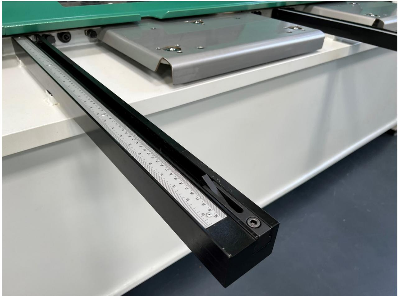
Vollmaterial mit seitlicher T-Nut für verschiebbarer Nocke und oben mm-Skala, Länge 1.000 mm
