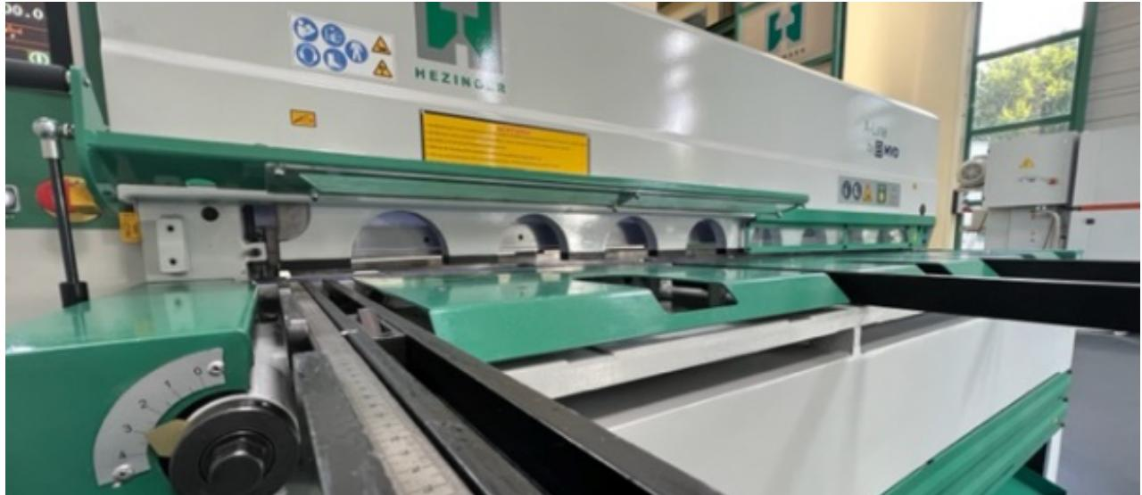
Der Fingerschutz kann auf den ersten 1.000 mm der Schneidlänge aufgeklappt werden, um kleine Blechstücke besser positionieren zu können. Ein Endschalter blockiert die Niederhalter und die Schneidfunktion – erst nach Schliessen des Fingerschutzes und der Quittierung auf dem Bedienpult kann wieder geschnitten werden – der Bediener wird optimal geschützt.
